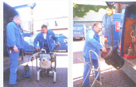
*Um schwere Werkstücke möglichst rückenschonend ver- und entladen zu können, wurden in zwei Firmenfahrzeuge Hebekräne bis 250 kg eingebaut. Der Pumpenmotor auf Bild 2 wiegt übrigens 125 kg!*
